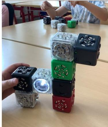
Durch die Bauweise der Cubelets werden die Grundlagen der Robotik (Action, Sense, Think) für jung und alt „begreifbar“ und "trennbar" gemacht.
